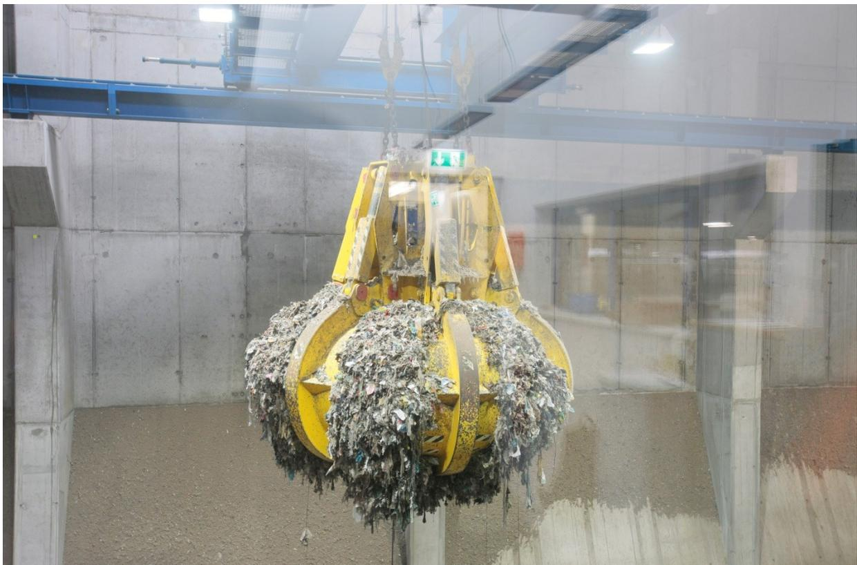
Abb. 77: Greifer im Bunker
