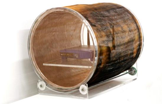
Der “WIFI Häcksler”, eine weitere Apparatur zerstört Wifi Signale, er arbeitet wie ein perforierter Faraday’scher Käfig. Videos, die über das WIFI Signal des im Käfig befindlichen Routers gesendet werden, können nur mit Störungen empfangen werden.
