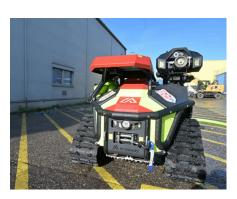
Der taktische Einsatzroboter Magirus Wolf R1 kann noch viel mehr als risikoreiche Löschaufgaben zu übernehmen. Mit seinen spezialisierten Kamerasystemen und Wärmebildkameras unterstützt er die Einsatzleitung, sich bei unübersichtlichen Situationen – etwa bei Dunkelheit oder starker Rauchentwicklung – schnell einen guten Überblick zu ver-
