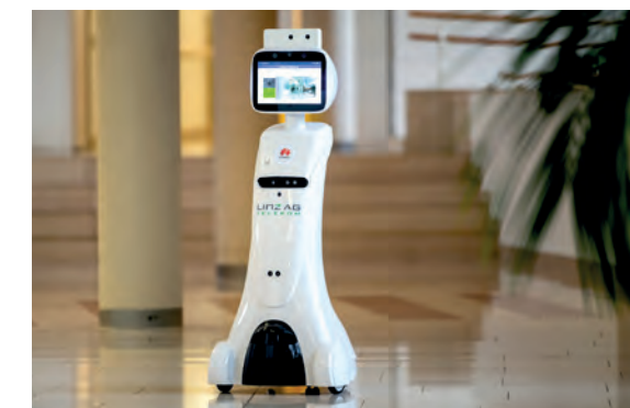
Der Roboter weist auf zu hohe Körpertemperaturen und auch auf fehlenden Mundschutz hin.
