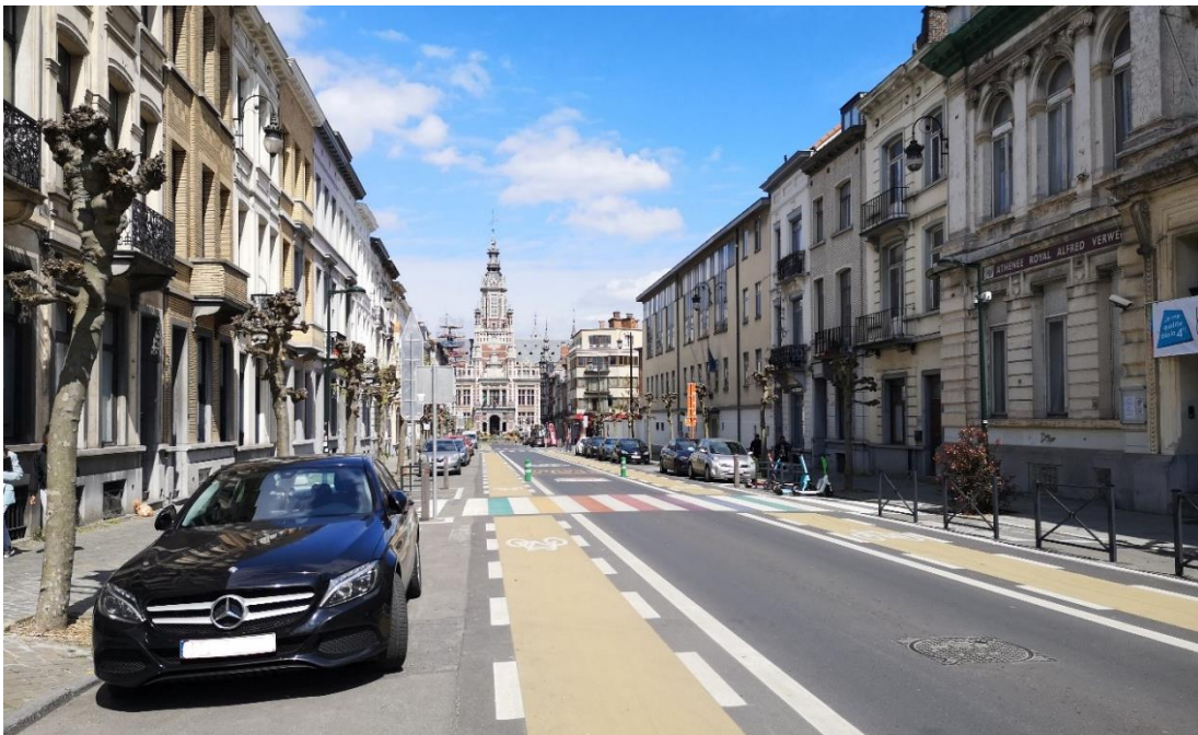
Abbildung 62: Best practice Brüssel: Mehrzweckstreifen mit Abstandstreifen und durchgängig markierten Schutzstreifen
