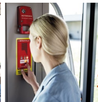
Für Notfälle! Gekennzeichnete Notsprechanlagen im Cityrunner.
