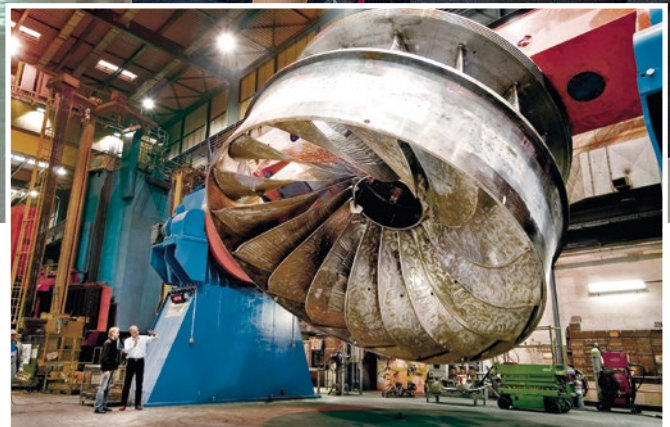
Spitzentechnik aus Linz: Wasserturbine von Andritz Hydro.
